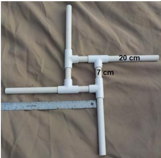
Рис. 2. Размеры коннектора (изготавливается из 20 мм труб)
