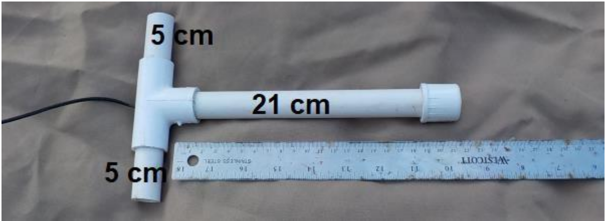
Рис. 2. Размеры коннектора (изготавливается из 20 мм труб)
