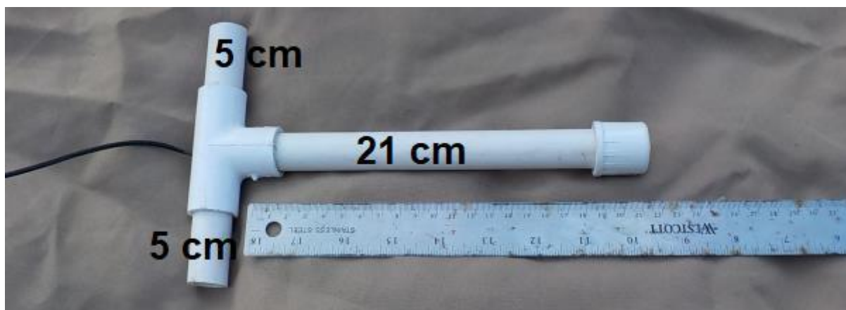
Рис. 2 – Размеры коннектора (изготавливается из 20 мм труб)
