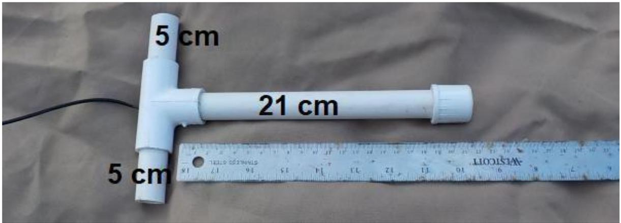
Рис. 2 – Размеры коннектора (изготавливается из 20 мм труб)
