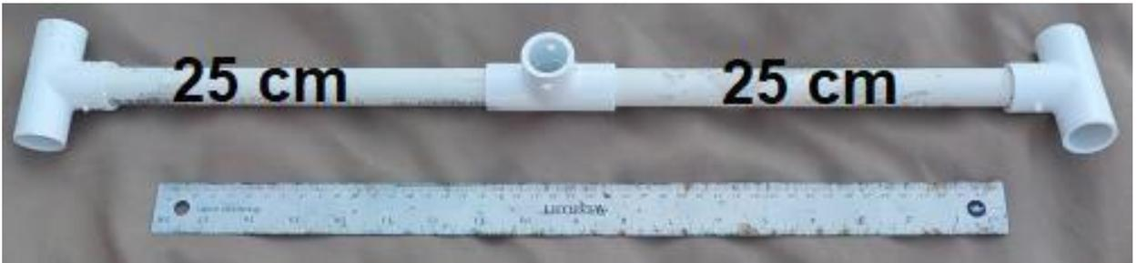
Рис. 10 – Рама, на которой закреплена сеть (высота рамы будем уменьшена)
