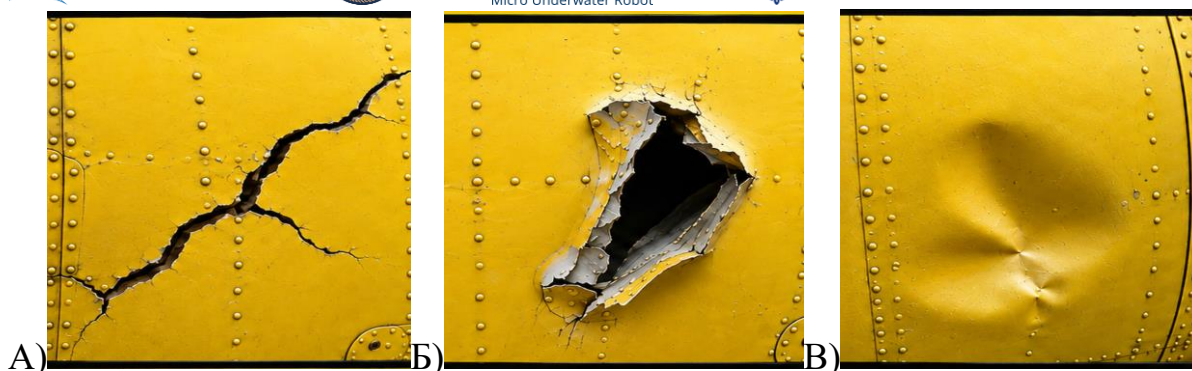
Типы повреждений на борту вертолета: а) - трещина, б) - разрыв, в) вмятина
