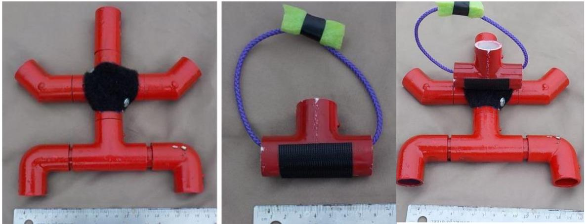
Рис. 19 – Звезда (слева), объект, имитирующий инъекцию (центр), инъекция (справа)
